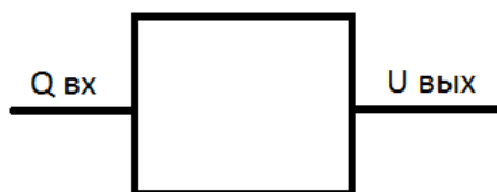
Рис. 9.1. Структурная схема ЦАП
