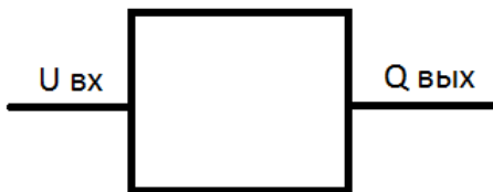
Рис. 9.3. Структурная схема АЦП
