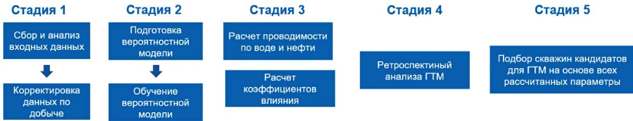
Рис. 14. Структура методики оптимизации разработки
