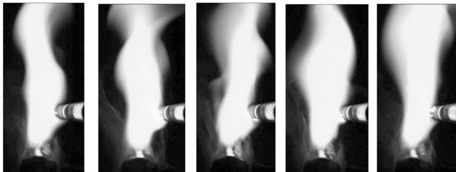
Рис. 3. Плазменный столб при разрядном токе  $I = 13$  А.  $x = 2,5$  см;  $h = 3,5$  см
