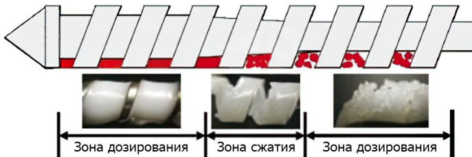
Рисунок 1 – Последовательность плавления пластика
