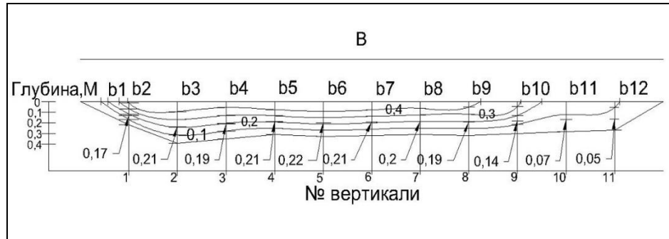
Рис. 3. Распределение скоростей в живом сечении русла
