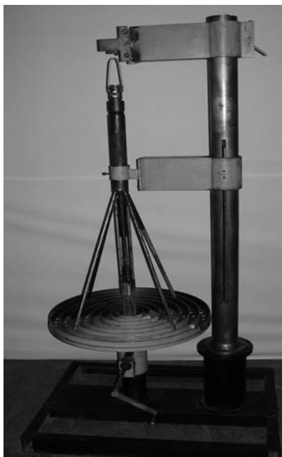
Рис. 3.3 Установки УПК-1 для калибровки и поверки каверномеров и профиломеров.
