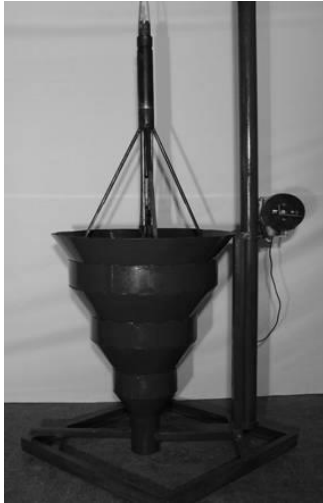
Рис. 3.4 Установка УАК-Кав-700 для автоматизированной калибровки каверномеров и профилемеров.
