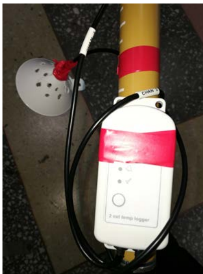
Рис.2. Градиентная мачта для регистрации приземных температурных инверсий в аэропорту г. Надым.
