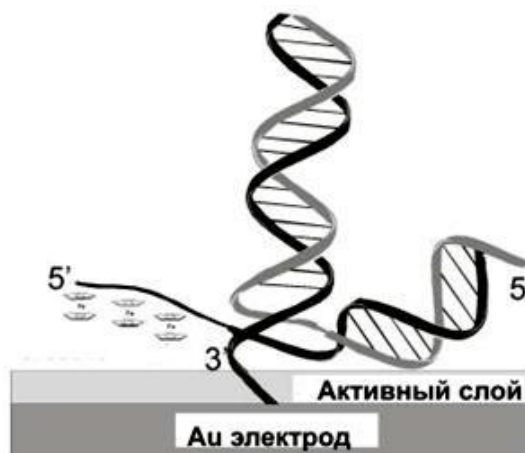
Рис. 12. Схема функционирования сенсора Motorola eSensor™
