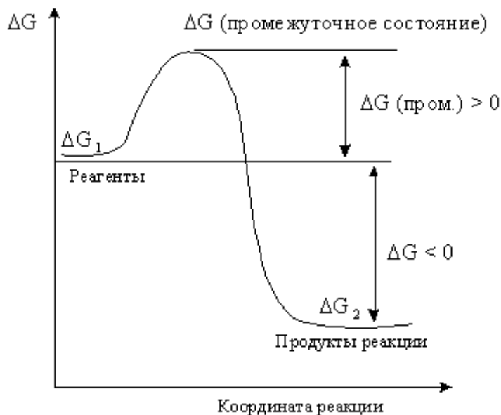
Рис. 31. Изменение энергии Гиббса реакционной системы при наличии промежуточного состояния с \Delta G_{\text{пром.}} > 0
