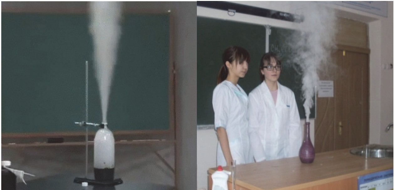
Рис. 29. Экзотермическая реакция разложения 30 % перекиси водорода под действием катализатора – диоксида марганца
