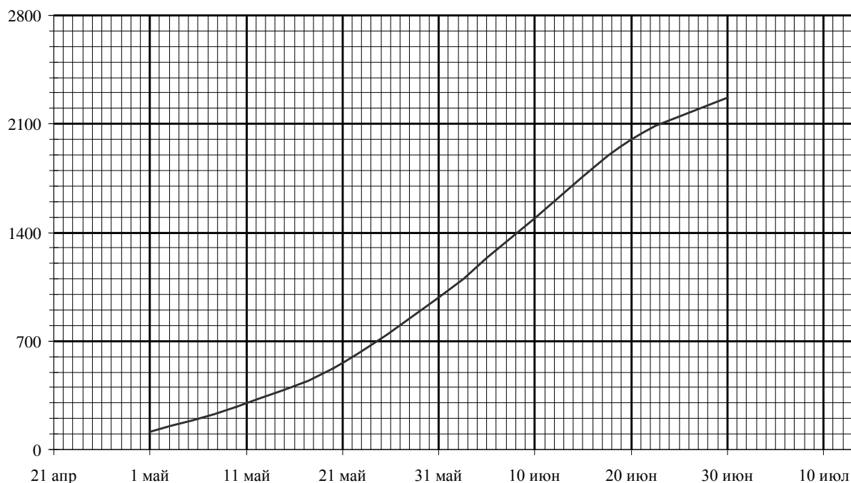
Рис. 1. Пример интегральной кривой дефицита водного баланса поливной Культуры (горохоовсяная травосмесь), построенной с помощью MS Excel
