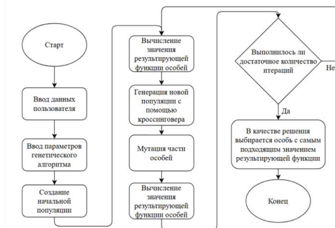
Рис. 3. Блок-схема генетического алгоритма составления рациона питания
