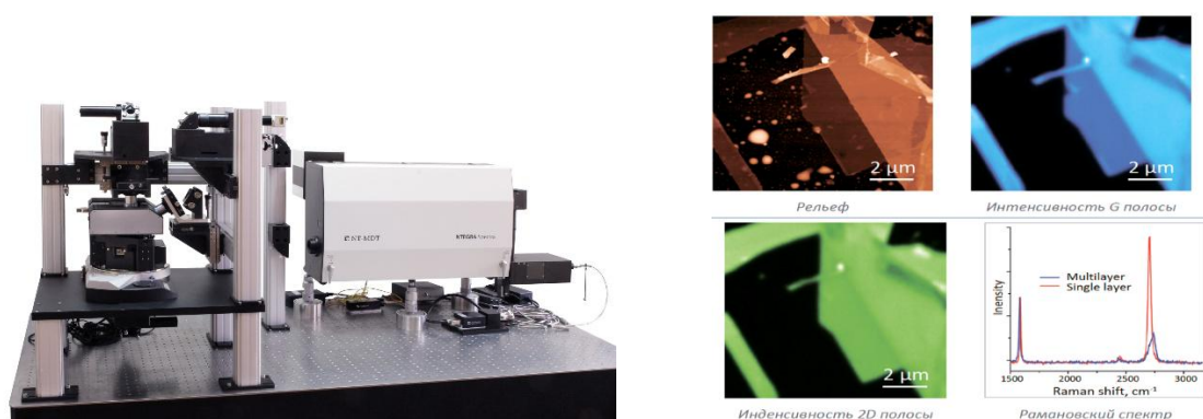
Рис. 1. Комбайн сканирующего зондового микроскопа и спектрометра комбинационного рассеяния света и изображения и спектры чешуек графена на Si/SiO 2
