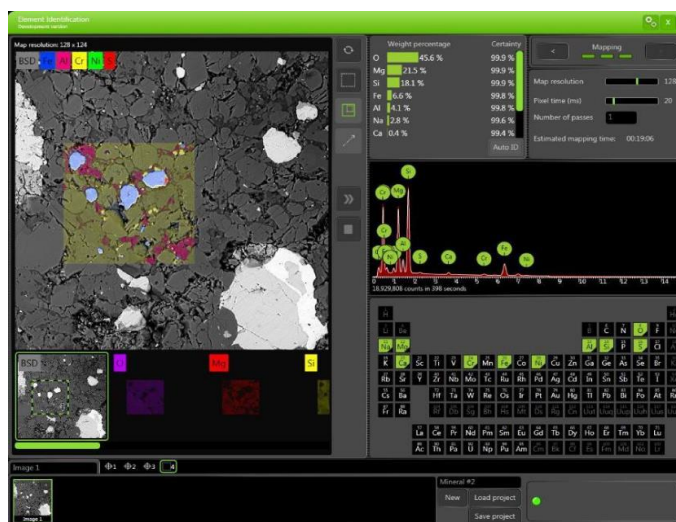
Рисунок 2. Пример ЭДС на микроскопе Phenom XL.
