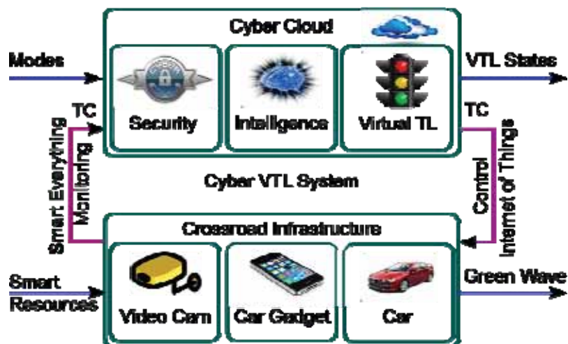
Рис. 1. Кіберфізична система VTL-управління транспортом на перехресті
