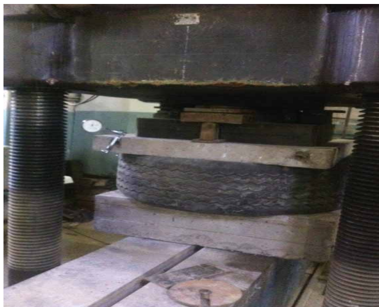
Рис. 2. Начальная стадия нагружения покрышки «Goodyear»
