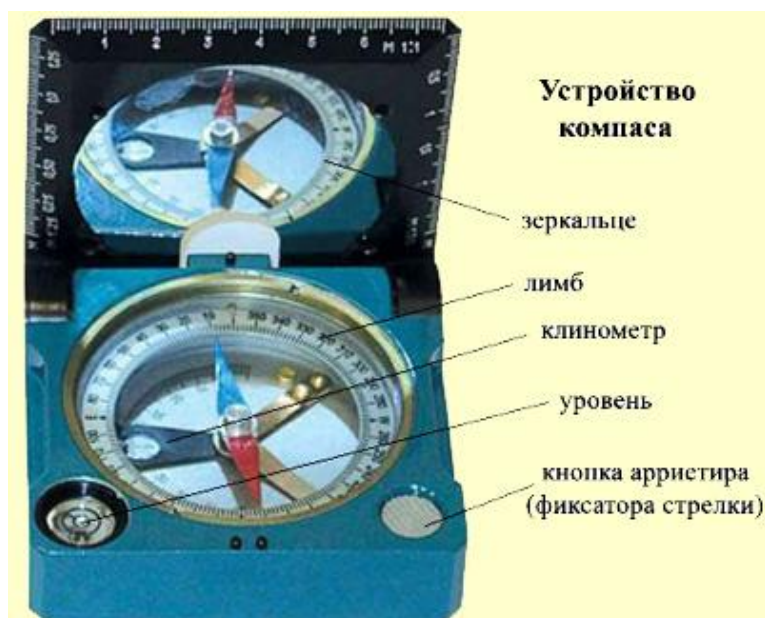
Рис. 4. Устройство компаса
