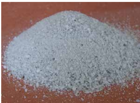
Рисунок 4. Высокремнистый халцедон после облучения и прокалики
