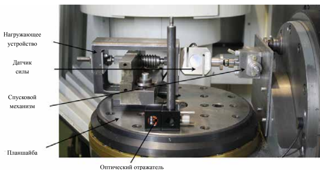
Рисунок 2. Устройство для измерения отклика несущей системы станка на ступенчатое силовое воздействие, настроенное для исследования динамической жесткости по координате C (планшайба)
