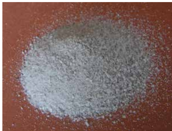
Рисунок 3. Высококремнистый халцедон после размола и прокалики
