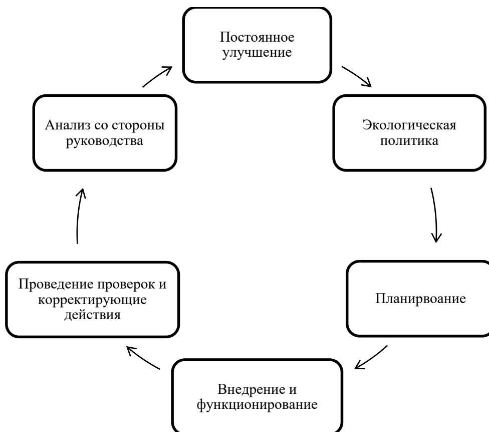
Рис. 8. Модель системы управления охраной окружающей среды на предприятии (согласно стандарту ИСО 14001)
