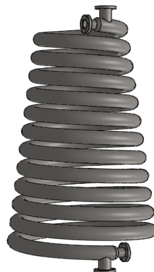
Рис. 87. Змеевиковый теплообменник типа «труба в трубе», выполненный на конус
