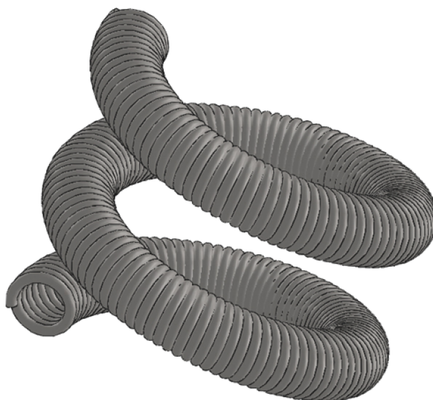
Рис. 36. Змеевиковый теплообменный элемент на базе пружинно-витого канала
