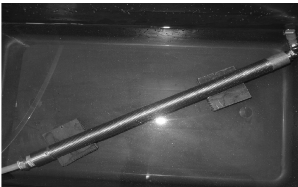
Рис. 83. Гидравлические испытания пружинно-витого канала
