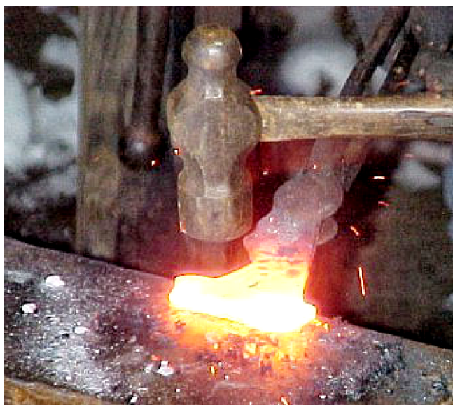
Рис. 1. Процесс кузнечной сварки
