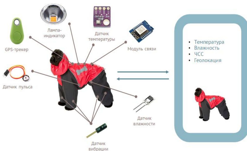
Рис. Схема взаимодействия умной одежды и приложения
