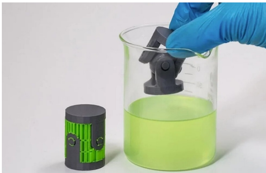
Рисунок 2. Удаление поддержек в d-лимонене
