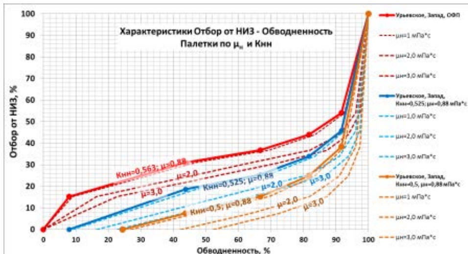
Рисунок 3. Палетки кривых выработки запасов для различных значений нефтенасыщенности и вязкости по нефти
