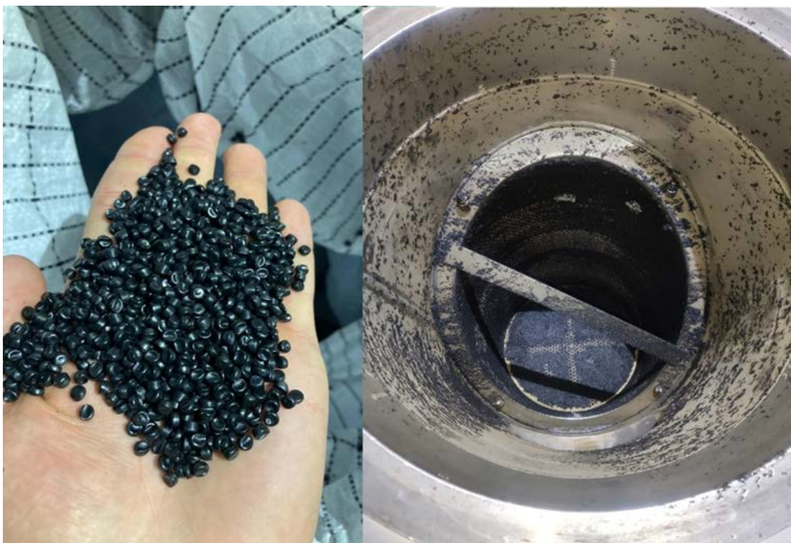
Рисунок 2. Внешний вид гранул и забитый фильтр гидротранспорта
