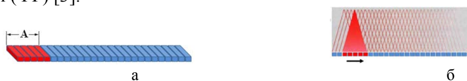
Рисунок 2. К методу ультразвуковой фазированной решетки: а – линейная одномерная решетка; б – принцип линейного сканирования
