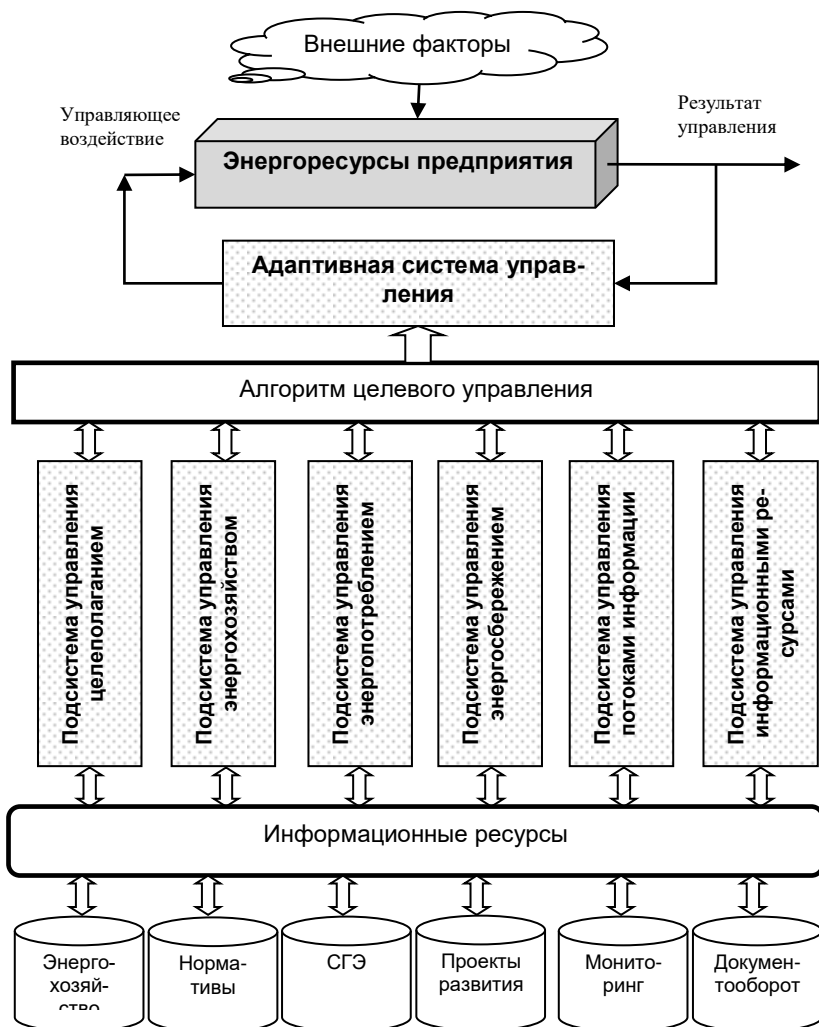
Рис. 5.6.3. Структурно-функциональная модель системы управления энергоресурсами предприятия
