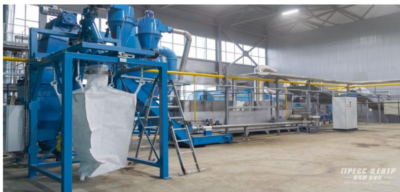
Рисунок 2. - Линия переработки углеродосодержащих отходов методом непрерывного пиролиза.
