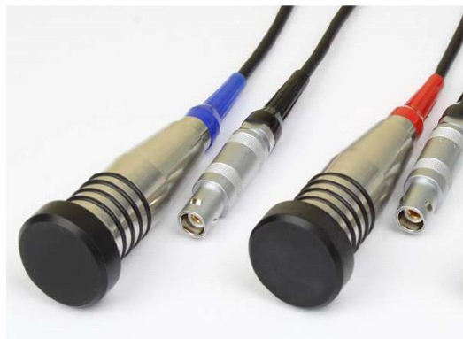
Рисунок 2. Ультразвуковые датчики на 1 (синий) и 2 МГц(красный).
