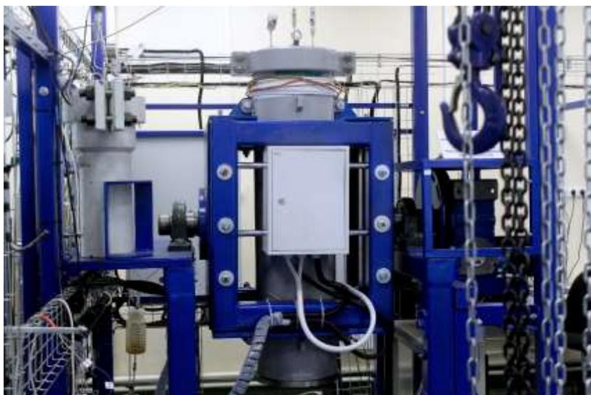
Рис.1.1 – Фото установки физико-химического моделирования процесса паротеплового дренажа
