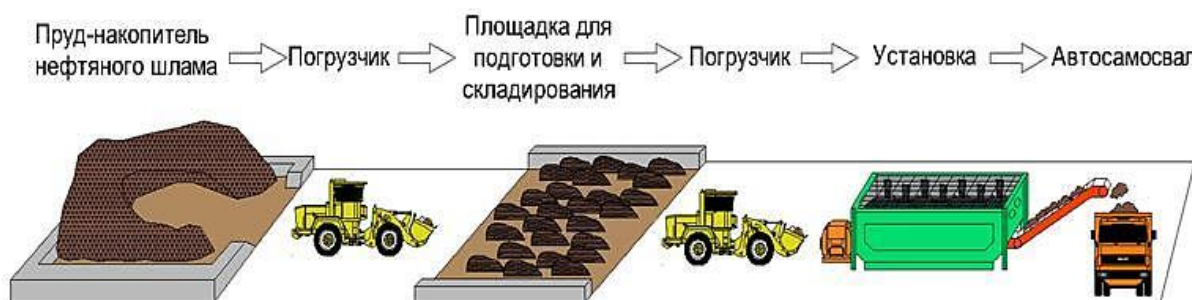
Рис. 1. Технологическая схема подготовки нефтяного шлама
