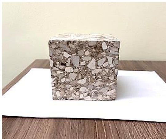
Рис. 3. Образец вырубki дорожно-строительного материала с применением нефтяного шлама
