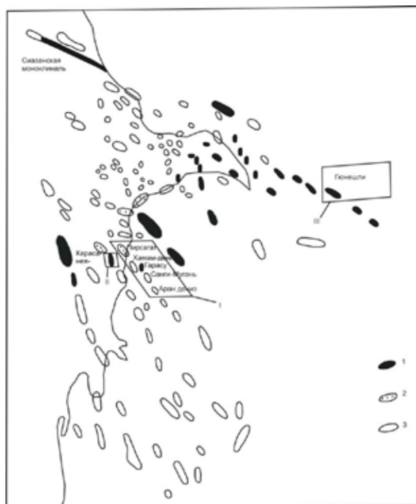
Рис. 1. Обзорная схема расположения исследуемых структур в ЮКВ. 1 - установленные залежи нефти; 2 - установленные залежи газа и газоконденсата; 3 - выявленные структуры; I, II, III - участки, где проводилась фаціальная интерпретация материалов ГИС
