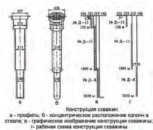
Рис.1. Конструкция скважин
