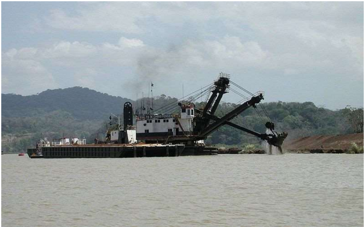
Рис.13. Земснаряд с одноковшовым экскаватором
