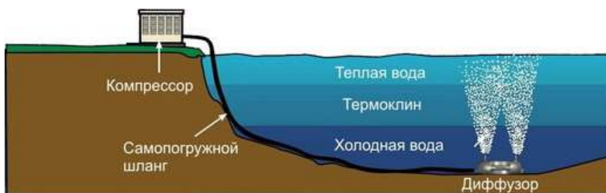
Рис. 21. Применение аэрационной установки в водном объекте
