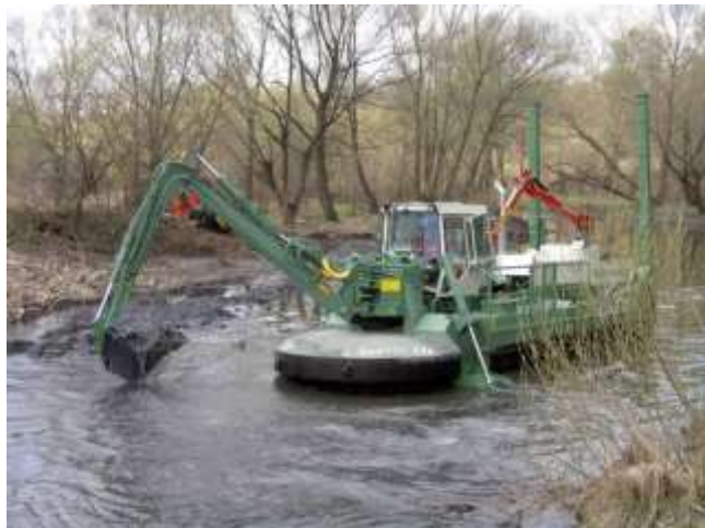
Рис. 18. Мобильный многофункциональный земснаряд «Акватория».
