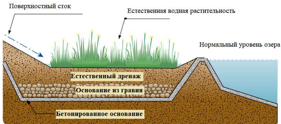
Рис. 24. Использование макрофитов для перехвата загрязняющих веществ поверхностного стока [19].
