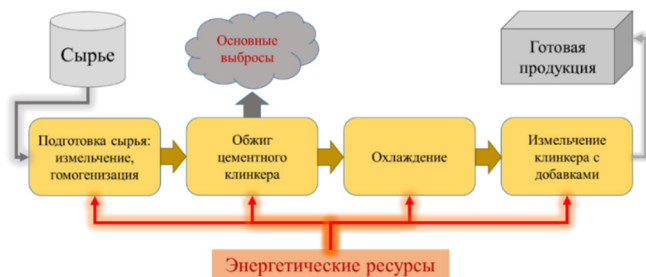
Рис. 3. Укрупненная структурная схема процесса производства цемента, (построено автором).
