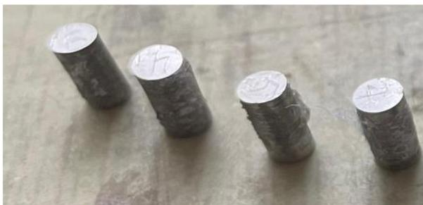
Рисунок 1 – Экспериментальные образцы для дилатометрии
