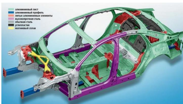
Рисунок 1- Каркас кузова автомобиля
