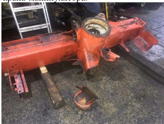
Рисунок 3- Перелом из-за холодной трещины
