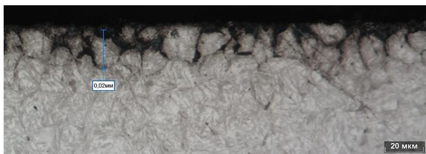
Рисунок 1 – Трооститная полоса и сетка в поверхностном цементованном слое детали, х 500
