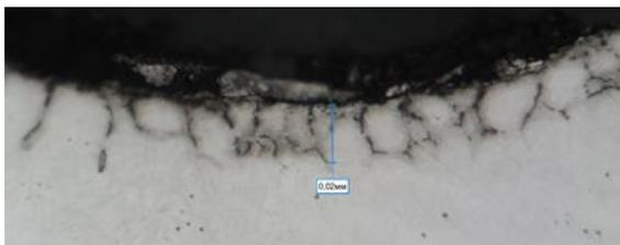
Рисунок 4а – Трооститная сетка по галтели щлицевого зуба детали, x500
