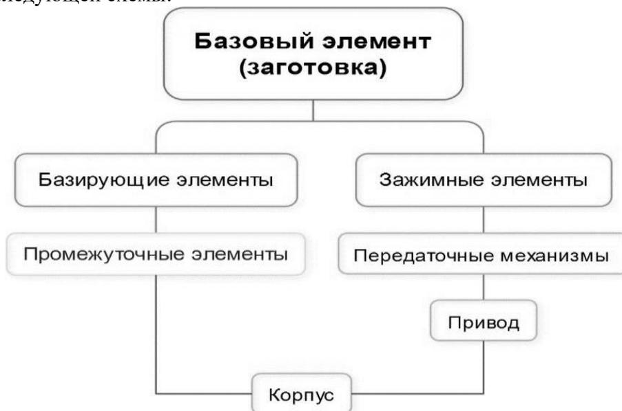
Рисунок 1 – Связи между компонентами приспособления
