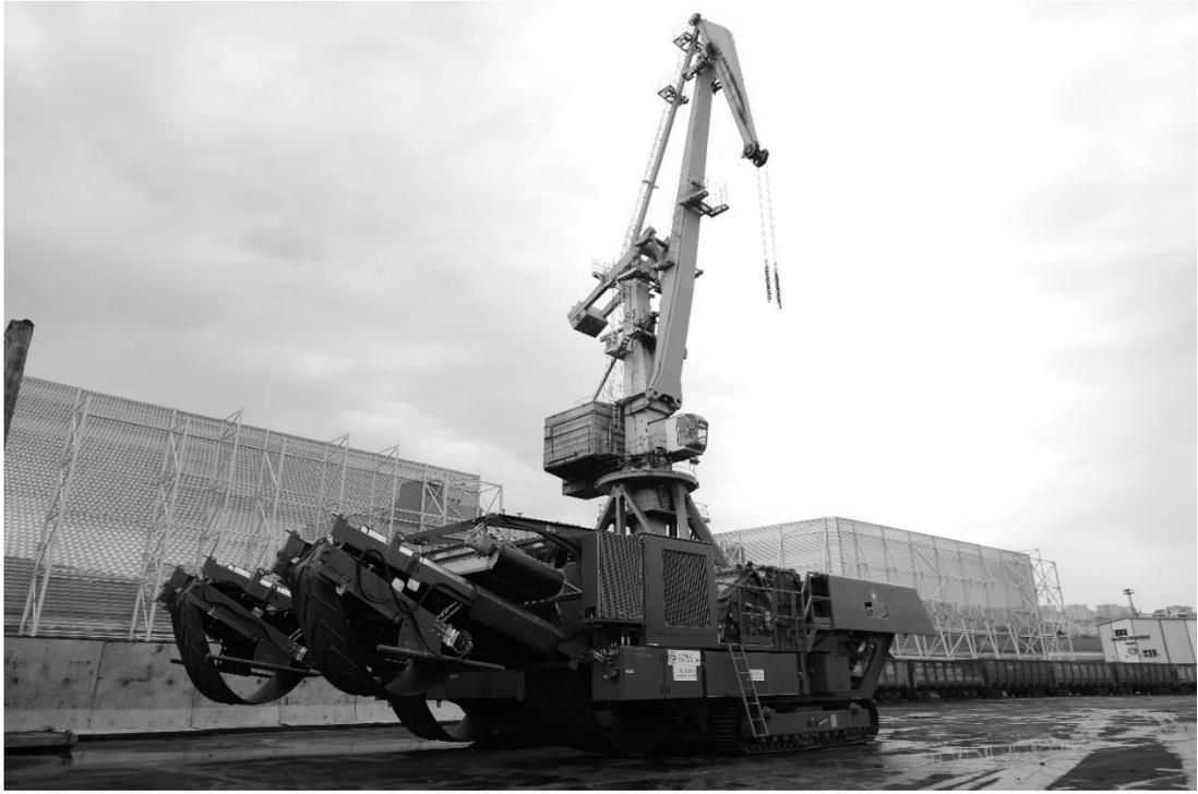
Рисунок 1 – Очистная, дробильно-сортировочная машина GIPIOREC
