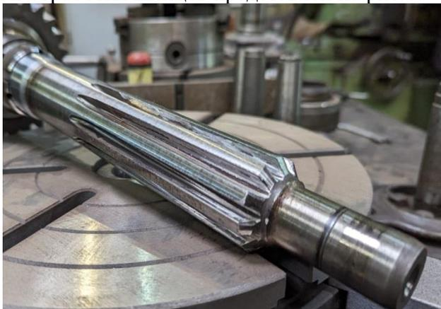
Рисунок 3 – Вал после механической обработки шлицев
