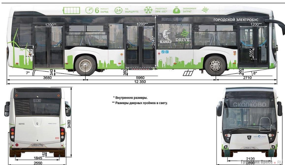
Рисунок 1 – Габаритные размеры электробуса модели 6282
