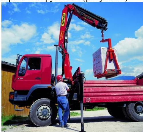
Рисунок 1 – Общий вид крана-манипулятора
