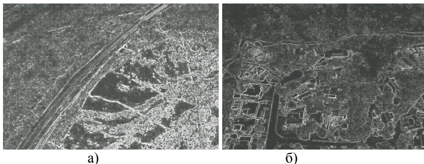
Рис. 3. Результат обработки исходных изображений методом фрактального ядра во всем диапазоне градаций яркости изображения
