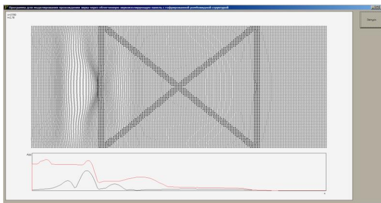
Рис. 3. Форма вывода результатов компьютерного эксперимента в разработанной программе: карты смещений узлов среды и графика зависимости амплитуды звука от продольной координаты
