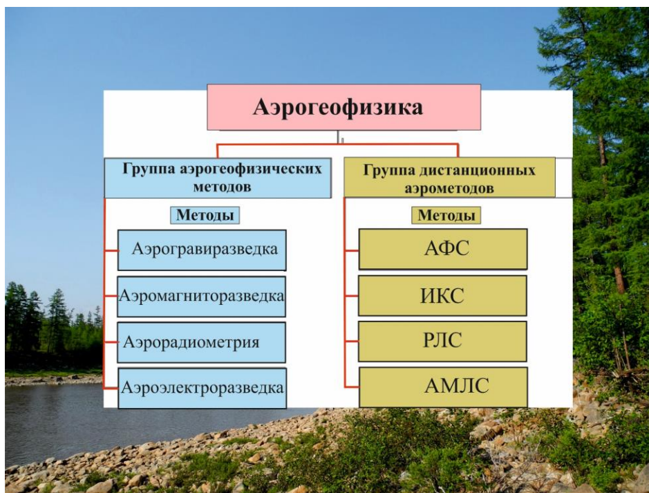
Рис. 6. Группировка аэрогеофизических методов АФС – аэрофотосъемка, ИКС – инфракрасная съемка, РЛС – радиолокационная съемка, АМЛС – аэромагнитная локационная съемка
