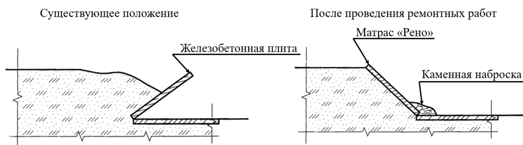
Рис. 4. Ремонт концевой части гасителя водосброса
