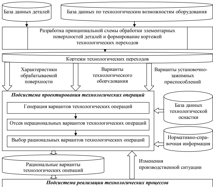
Рис. 2. Структурная модель подсистемы проектирования операций механической обработки
