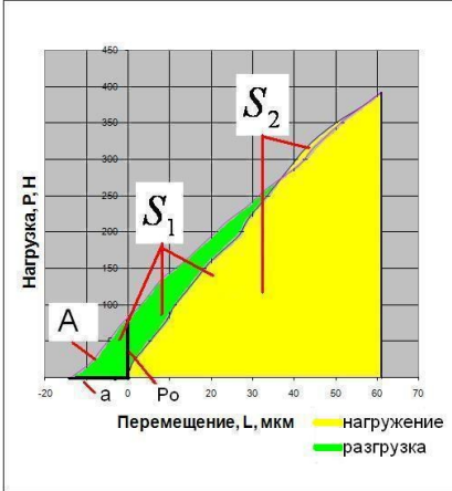
Рис.3. Диаграмма деформирования керамического слоя покрытия в процессе нагружения и разгрузки
