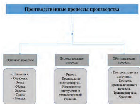
Рисунок 1 - Классификация процессов производства
