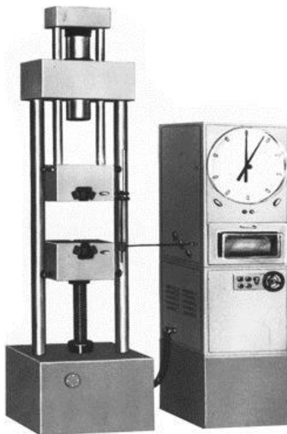
Рис. 4. Разрывная машина Р-20
