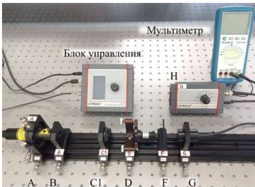
Рис. 20. Внешний вид экспериментальной установки, F – светофильтр RG1000
