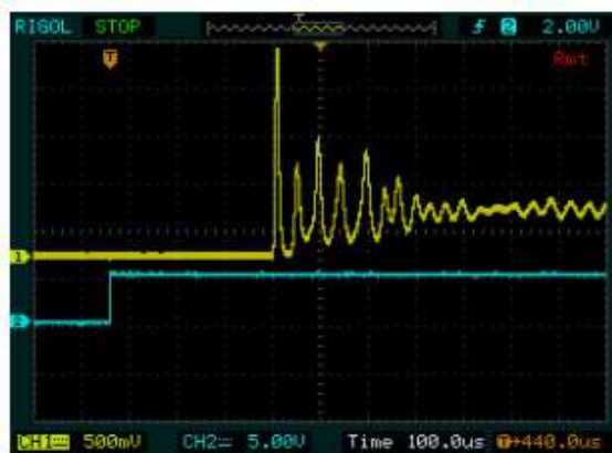
Рис. 13. Пиковый режим работы Nd:YAG лазера. На верхней кривой изображены лазерные осцилляции. На нижней кривой изображен модулированный сигнал тока инжекции накачки диодного лазера
