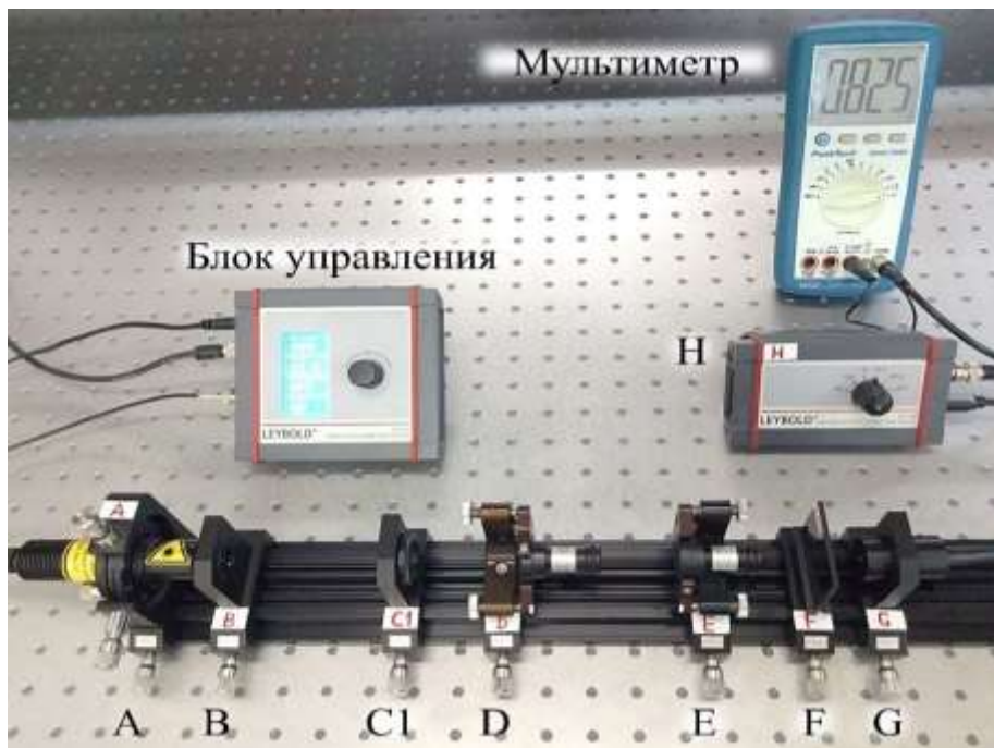
Рис. 23. Внешний вид экспериментальной установки. Полусферический резонатор Nd:YAG лазера образован плоским зеркалом, расположенным на торце кристалла (D), и плоским зеркалом (E). Ручка усилителя сигнала фотодетектора установлена в положение «10 К»
