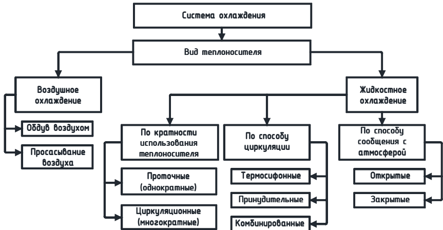
Рисунок 7 – Классификация системы охлаждения двигателя
