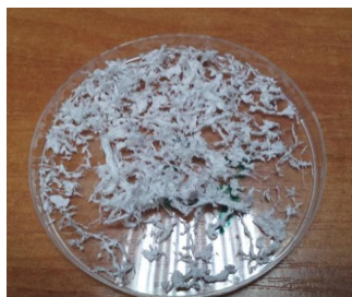
Рис.2. Обработанный образец при параметрах ПМК 150^{\circ}\text{C} , 40 МПа.
