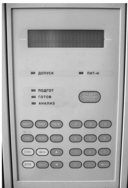
Рис. 4.12. Панель контроллера хроматографа «Кристалл 2000»
