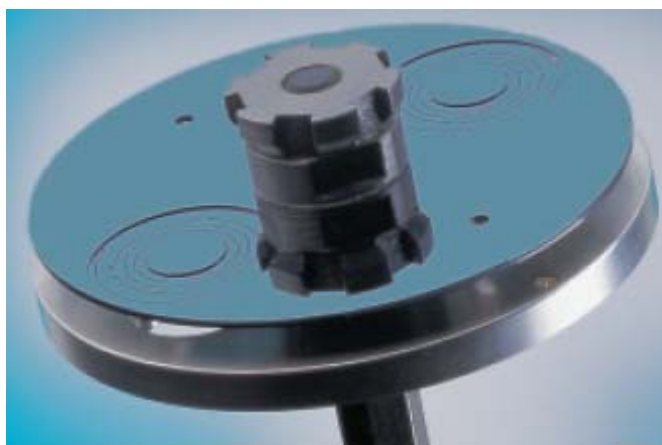
Рис. 2.20. Сенсор дифференциального сканирующего калориметра DSC 204 F1 Phoenix
