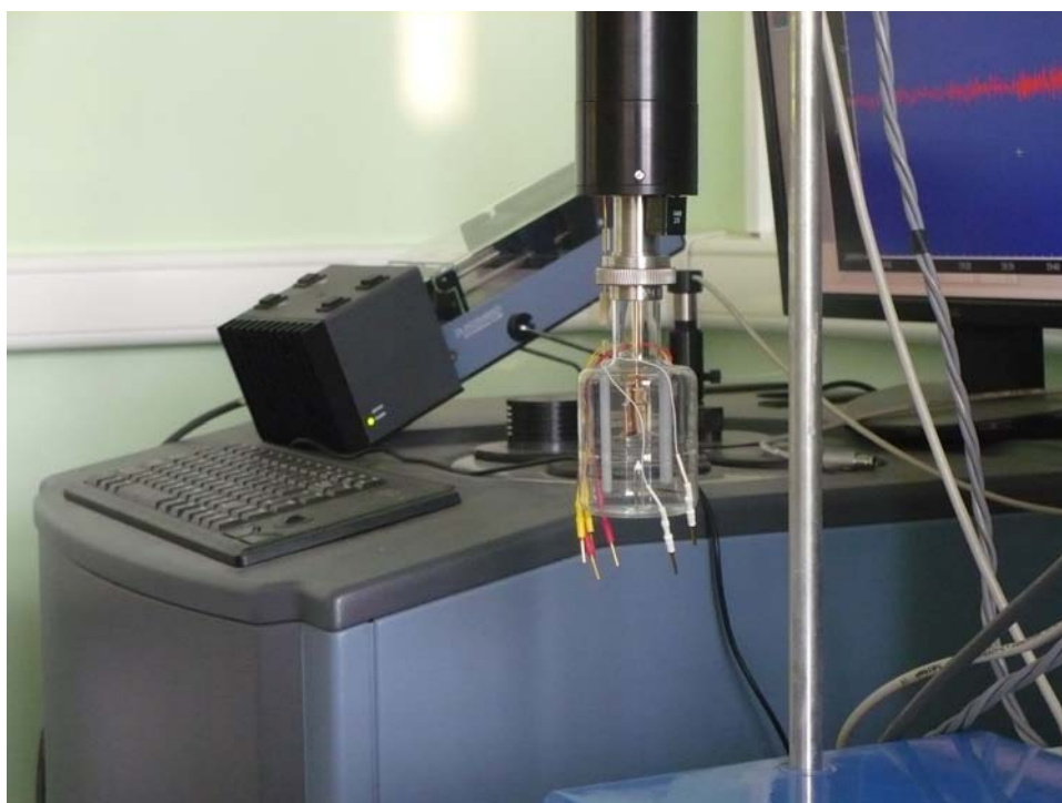
Рис. 2.9. Прецизионный калориметр растворения-титрования, производимый фирмой «ГА Instruments». На переднем плане – калориметрическая ячейка; на заднем плане – термостат ТАМ III.
