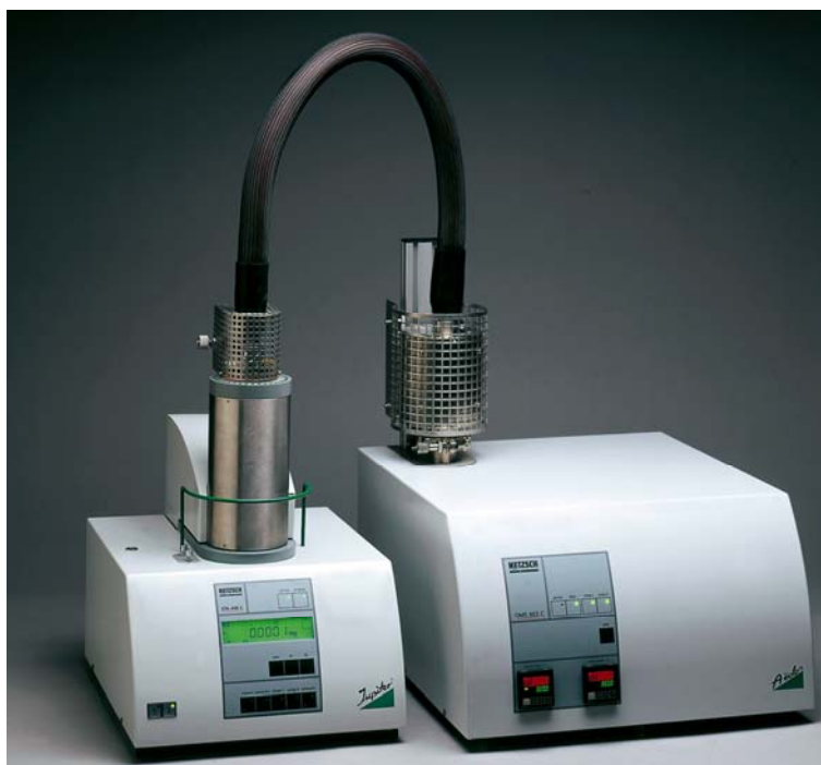
Рис. 2.24 Фотография совмещенного ТГ/ДСК термоанализатора STA 449C Jupiter (слева), сопряженного с квадрупольным масс-спектрометром QMS 403C Aeolos (справа)
