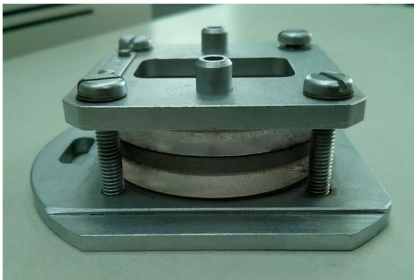
Рис. 1.22. Общий вид ИК спектроскопической кюветы.
