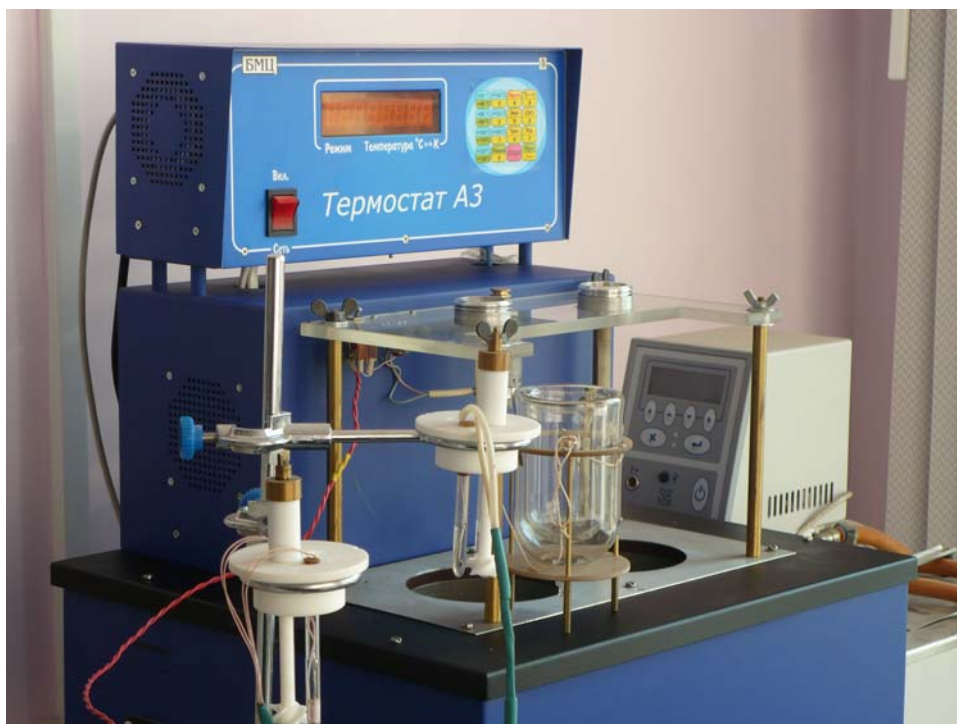
Рис. 2.8. Калориметр растворения, изготовленный сотрудниками кафедры физической химии КФУ
