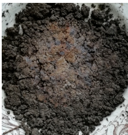
Рисунок 2. Опыт с индикацией горизонтального слоя почвы по центру смоченной медным купоросом избыточным количеством порошка железа.
