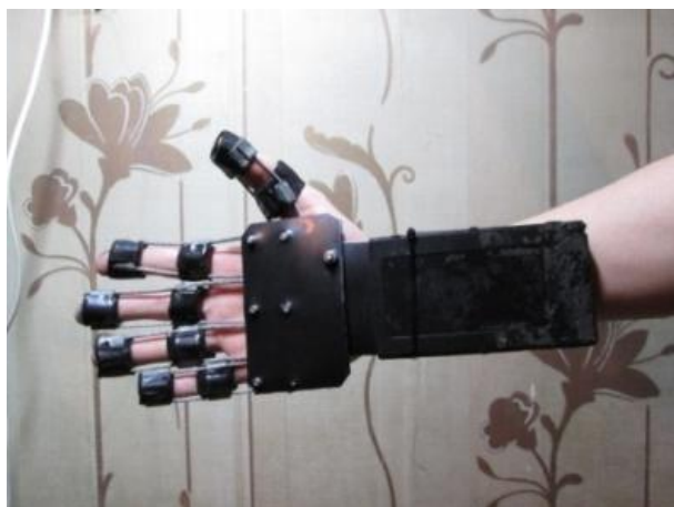
Рис. 1 – Перчатка, усиливающая мышечную силу руки
