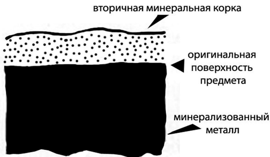
Рис. II.8. Полная минерализация археологических предметов из металла
