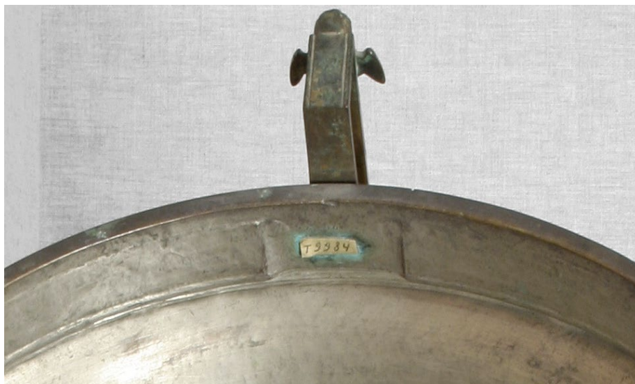
Иллюстрация III.2. Неправильная маркировка музейного предмета, вызывающая коррозию металла (фото Е.В. Виноградовой)
