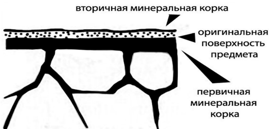
Рис. II.7. Образование первичной и вторичной минеральной корки на археологических предметах из металла
