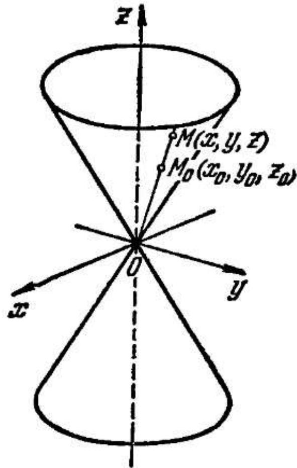
Можно сказать, таким образом, что эллиптический конус получается при движении прямой (образующей), закрепленной в одной точке, по эллиптической направляющей.
