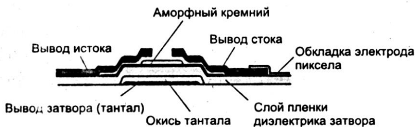
Рис. 2.14. Структура TFT-транзистора на аморфном (a-Si) кремнии
