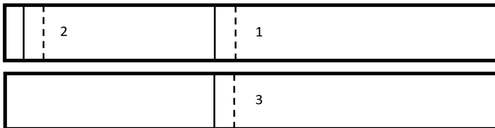
Рисунок 1. Расположение зон измерения на пластинах (1 – зона сжимающих напряжений на внутренней стороне, 2 – зона без напряжений, 3 – зона растягивающих напряжений на внешней стороне, пунктирные линии – линии измерений фокусного расстояния до точек, сплошные линии – линии нулевых отметок)
