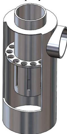
Рисунок 1. Трехмерная модель центробежного классификатора с соосно расположенными трубами
