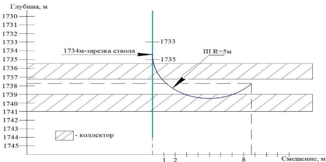
Рисунок 2. Профиль перфорационного канала 3-го типа
