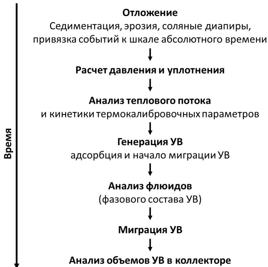
Рис. 3. Рабочий процесс построения бассейновой модели по [2]
