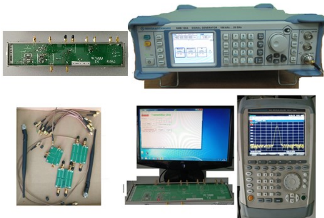
Рис. 1. Состав оборудования: учебный набор ME1000 (модуль передающей части), генератор сигналов R&S®SMB100A, анализатор спектра FSH8, компьютер
