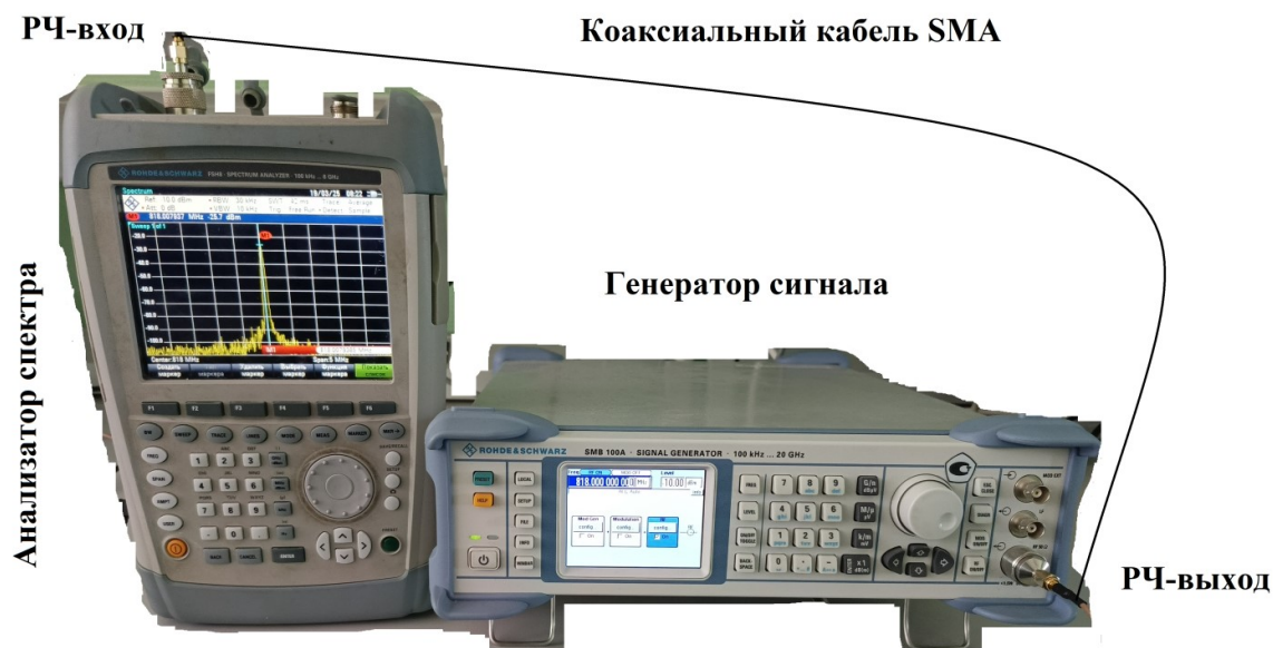
Рис. 12. Проверка ГС и калибровка потерь в коаксиальном кабеле SMA
