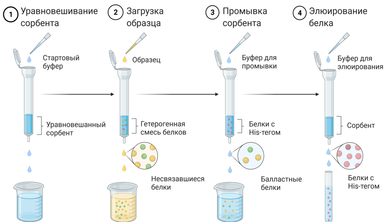
Рис. 13. Схема проведения хроматографии в колоночном формате
