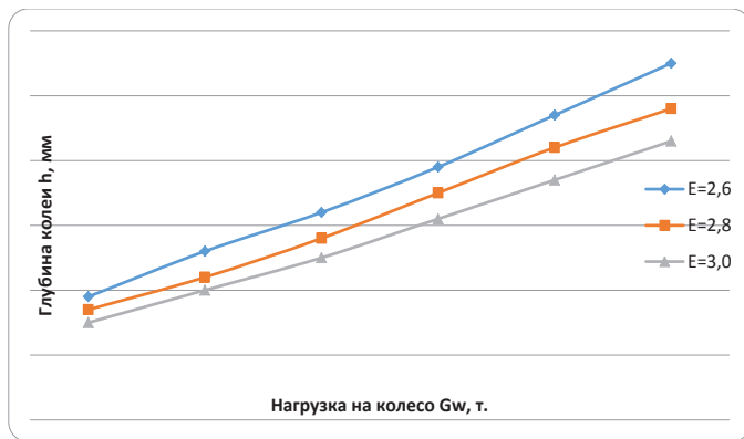
Рисунок 1 - Зависимости глубины колеи h от нагрузки на колесо G_w и от модуля деформации E
